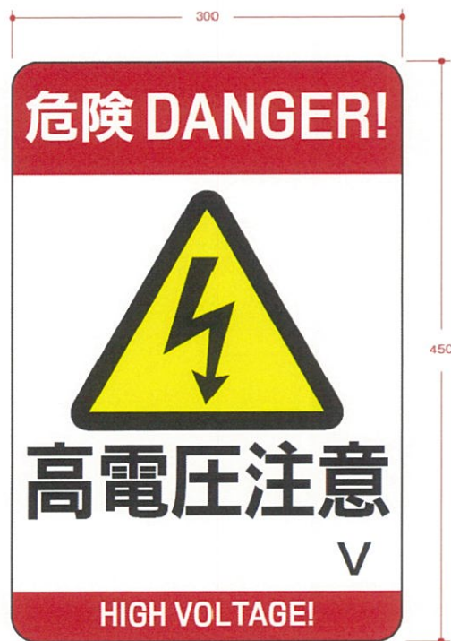
「危険高電圧」標示看板
